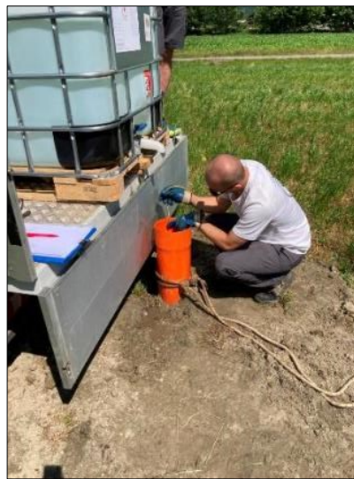
Fig. 5 - Esecuzione di prova di permeabilità in sito.
